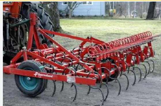
Figure 26 : Photo d'une herse peigne permettant de réaliser le hersage (Wikipédia).
