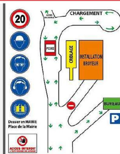
Figure 6 : Plan de circulation des engins sur le chantier et zones de stockage (Prévencem)
